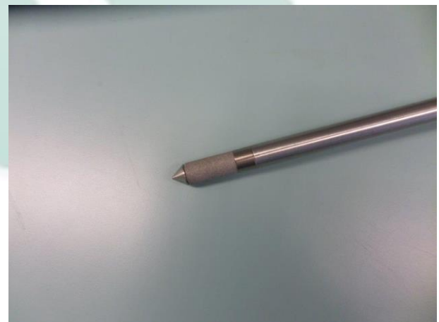
Misura dell'UR+T° in prossimità della punta del sensore.
