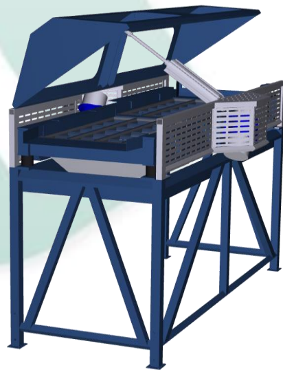
Piccola calibratrice piatta con dimensioni da 400 mm fino a tre frazioni. Utilizzata per la pulizia dei semi da laboratorio e pellet.
