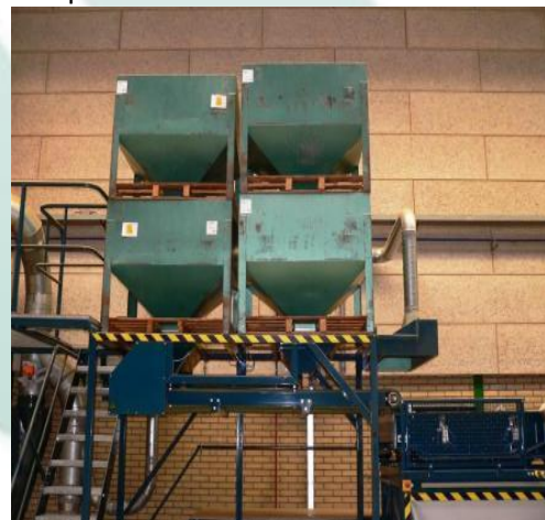
I cassoni con tramoggia in alto dosano i semi nei cassoni con tramoggia inferiori. Da lì i semi saranno trasportati tramite un nastro verso la calibratrice piatta.
