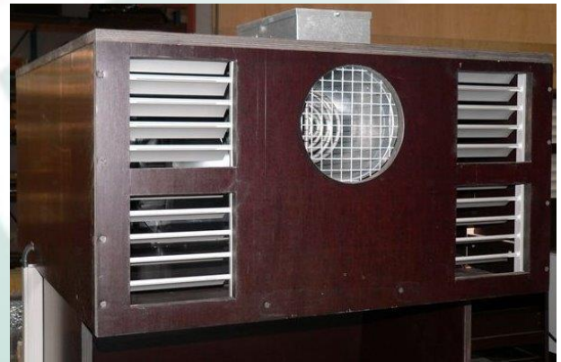
Unità di estrazione inclusi riscaldamento e valvole.
