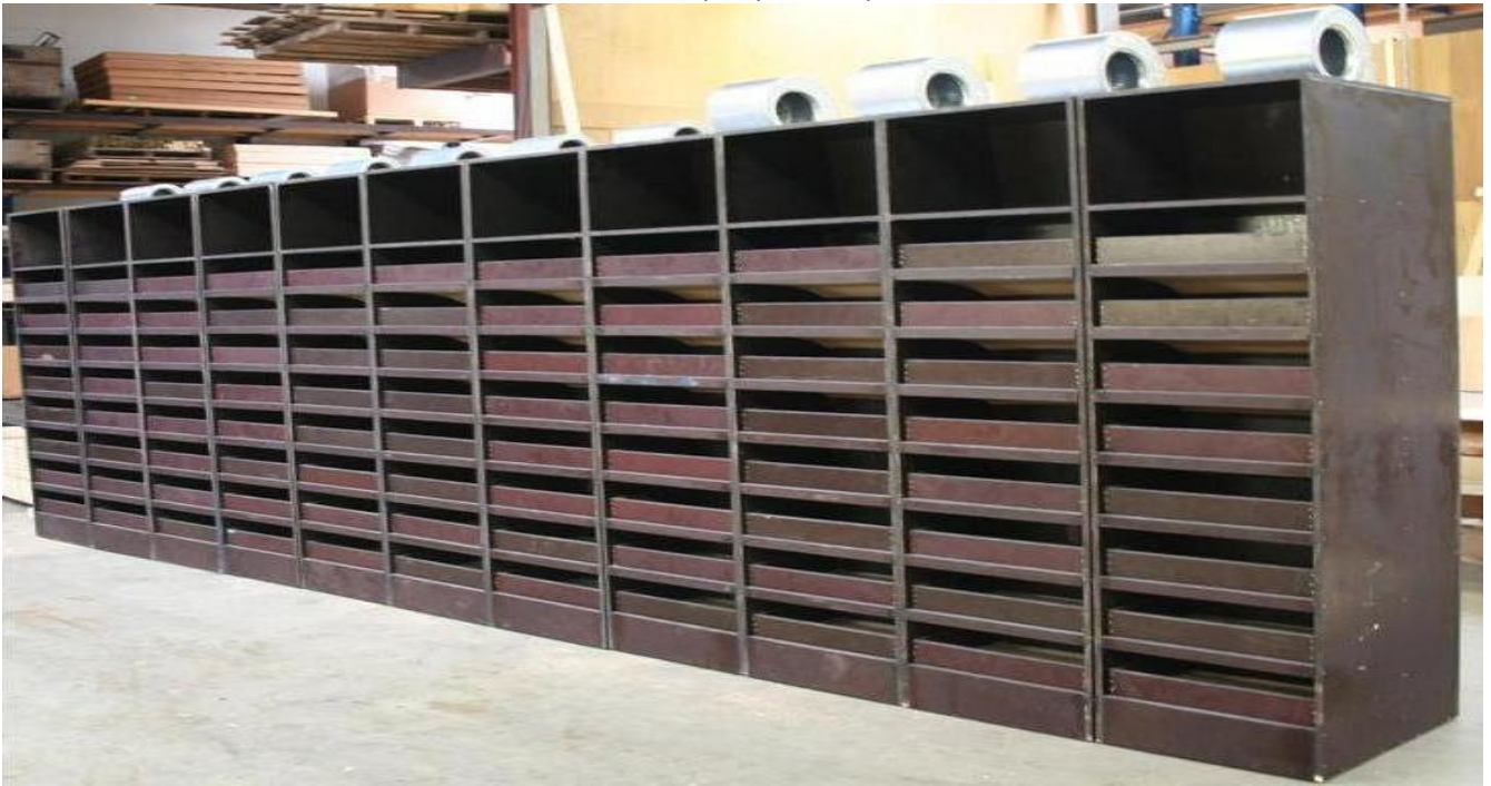
Unità di essiccazione / ventilazione per cassette.
