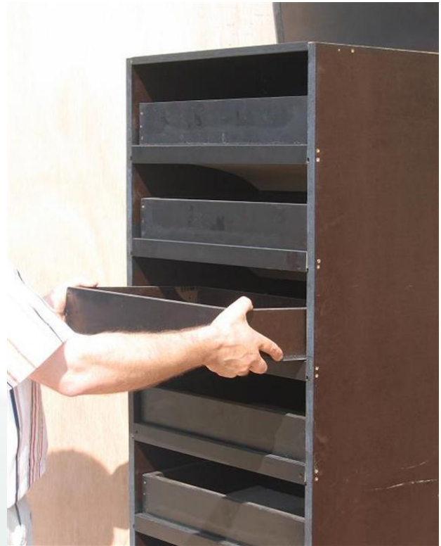
L'ingresso dell'aria si apre quando il cassetto viene posizionato.
