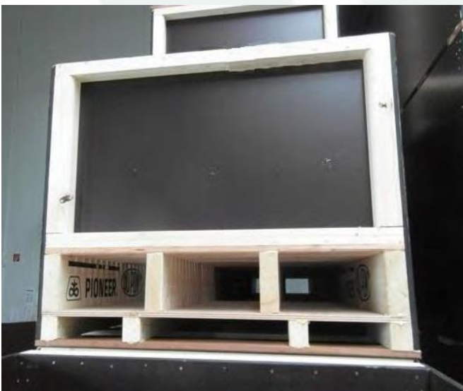
Esempio di cassone di essiccazione con doppio pallet: ventilazione e trasporto. Cassone con un lato esterno in betonplex.
