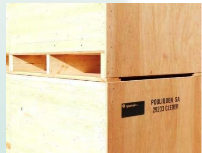
La fessura che si crea per la differenza di spessore tra gli strati di cassoni fa uscire l'aria umida.
