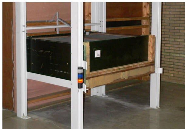
Delle lampadine led indicano lo stato di avanzamento del processo di essiccazione. Arancione: essiccazione avviata, blu: ultima fase, bianco: essiccazione completata.
