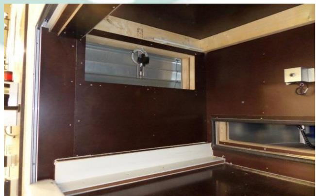
Scarico dell'aria con sensore di T°+UR per misurare il processo.
