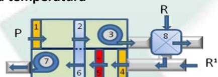
**Opzione I) 8:** Lo scambiatore di calore abbassa la T° di processo fino al livello ambiente di + 3°C. L'energia liberata viene utilizzata per riscaldare l'aria per la rigenerazione; Risparmio energetico.
