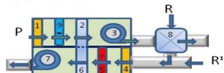
**Opzione III) 8+9:** Risparmio energetico e raggiungimento di una T°C desiderata qualsiasi per l'aria di processo in uscita. Sistema ibrido con scambiatore di calore.
