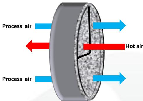
Rotore con una configurazione 75-25; rigenerazione tramite aria calda (150°C) di un bruciatore a gas sul 25% della superficie del rotore.
