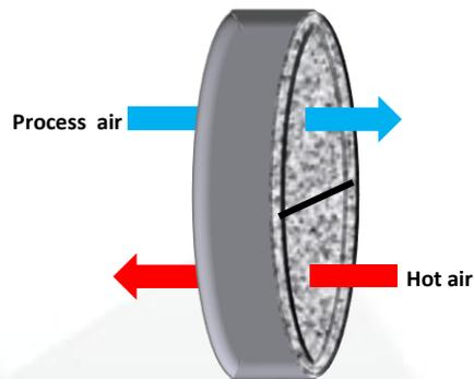
Rotore con una configurazione 50-50; rigenerazione tramite aria calda (60°C) da una batteria d'acqua calda o condensatore.
