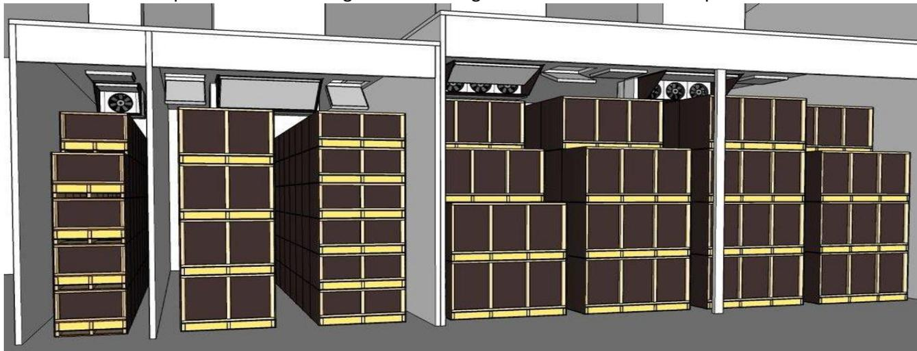
La disposizione e le dimensioni delle celle sono determinate in base alle necessità e all'utilizzo; 1 o più file di cassoni per cella o 1 grande cella con essiccatori presenti su entrambi i lati, 3-4-5-6 cassoni impilati in altezza. Possibilità di avere dei volumi da 30 a 40 m<sup>3</sup> per fila.
