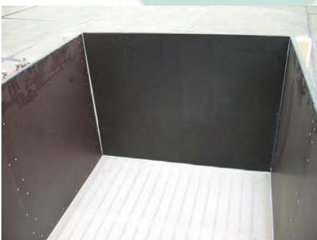
Cassone di essiccazione con fondo fessurato e reticella a maglie fini.
