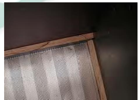
Cassone di essiccazione con fondo perforato per sementi grossolane (fagioli, mais, ecc).
